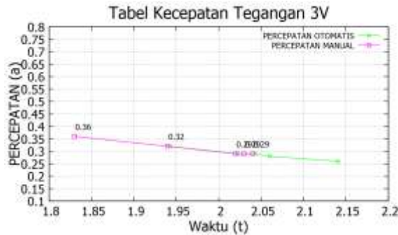
Grafik 4. Plot percepatan terhadap waktu dengan tegangan 3 V pada percobaan secara otomatis dan manual setelah pengukuran kedua
