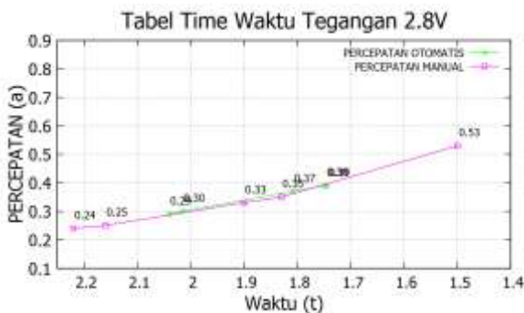
Grafik 2. percepatan terhadap waktu dengan tegangan 2.8V pada percobaan secara otomatis dan manual setelah pengukuran kedua
