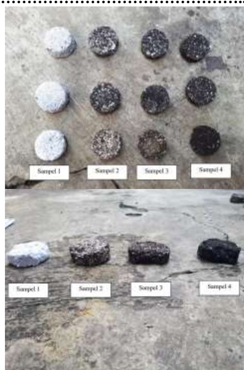
Gambar 6. Tampak Visual Biobriket Sebelum dan Sesudah diuji Shatter Index
