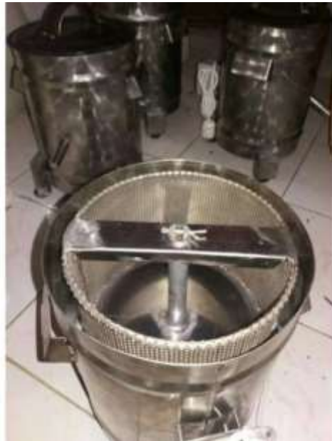
Gambar 4. Spinner Pembuatan Abon Ikan Tuna
